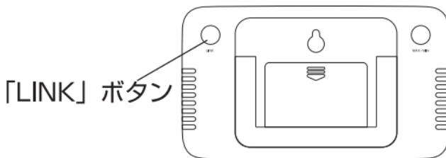
本体の測定値表示部が「--. --°C, --%」で点滅し、子機から送られる電波の待機状態になります。
