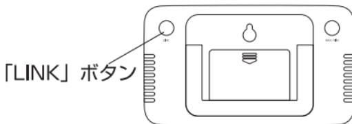
2. 5分以内に子機の電池を2個とも新しい電池に交換する。
